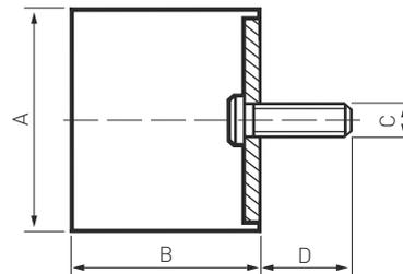
a) A - Diâmetro exterior do Apoio | B - Altura | C - Rosca | D - Comprimento do Perne
